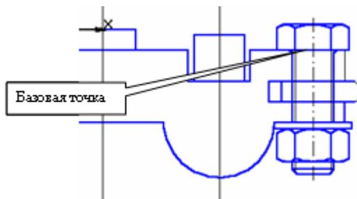
болтового соединение в заданное положение по базовой точке и зафиксируйте положение болтового соединения, рис. 6.
