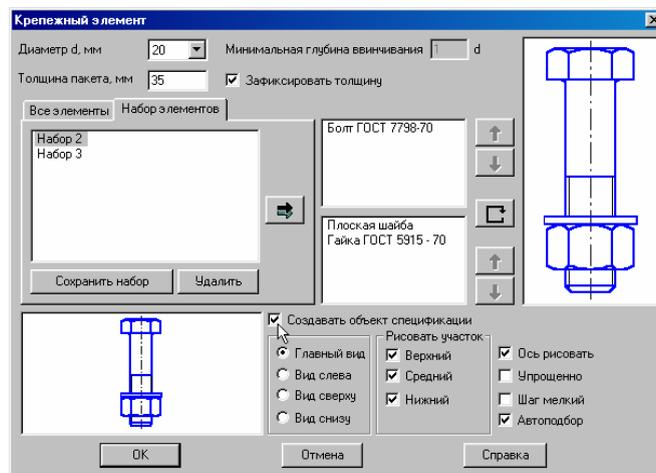
верхнее окно болт, а в нижнее – сначала шайбу, а затем гайку.
