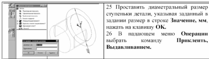
27. В окне **Параметры** установить следующие параметры операции выдавливания: **Прямое направление** и **Расстояние: 22 мм**, нажать клавишу **Создать**.
